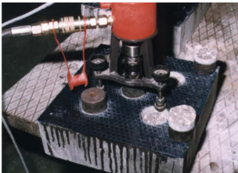
Esecuzione del test secondo UNI EN 1542
