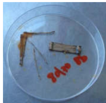
Fibre corrodibili, prova non superata
